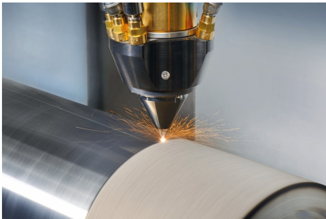
Bild 1: Mit dem Ziel, Bauteile effizienter reparieren und beschichten zu können, wurde die Prozesskette an einer Heizwalze mit korrosionsbeständigem Pulver auf Eisenbasis erprobt. © Fraunhofer ILT, Aachen.
